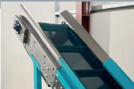
Tratto amagnetico in acciaio inox AISI 304
