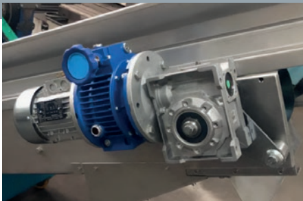
Motoriduttore con variatore meccanico
