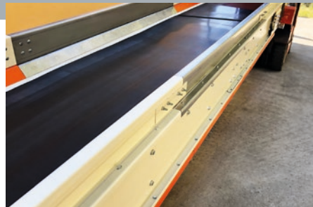
Sección no magnética de acero inoxidable AISI 304
