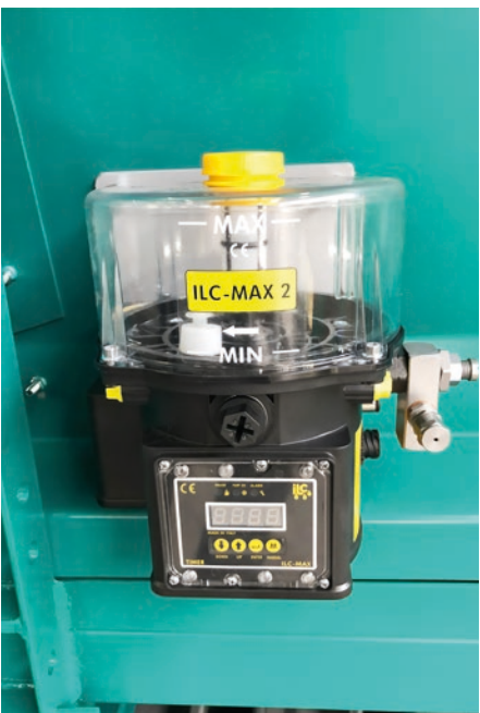
Central de lubricación hidráulica
