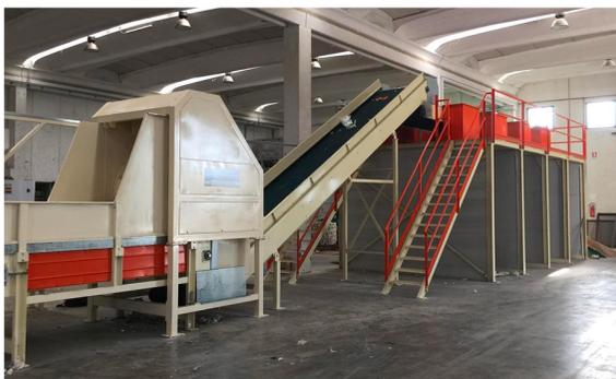
A seguito del nostro processo evolutivo, oggi come oggi siamo specializzati nella realizzazione di: **nastri trasportatori** adattabili in termini di dimensioni, capacità di carico e altre caratteristiche in base alle esigenze del cliente.
